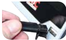
■ Puerto USB frontal: importar/exportar ficheros de marcaje – Conexión para teclado externo
